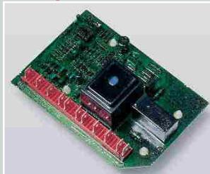
Устройство, контролирующее состояние изоляции между IT-сетью и защитным проводом на соответствие нормам VDE 0100 части 410 с аварийной индикацией.
