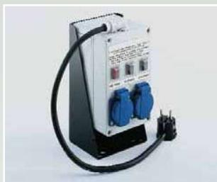
Дополнительное защитное устройство GW 308, контролирующее утечку тока с силовым автоматическим выключателем и индикацией неисправности. Применяется, в основном, в области газового и водного хозяйства. Внешнее, на 230 В.
