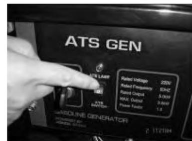
1.5. Переведите ключ запуска на панели управления в положение «ВКЛ». После этого генератор будет пропускать через себя напряжение основной электросети на подключенную нагрузку. **Следует обратить особое внимание**, что мощность подключенных приборов суммарно не должна превосходить номинальную мощность генератора!
