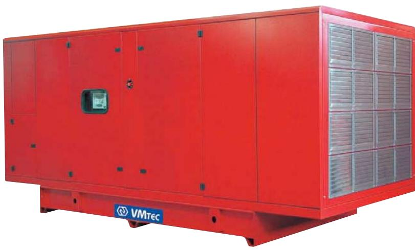
Малошумные одно- и трехфазные генераторные установки с четырехтактными дизельными двигателями и синхронными одноопорными четырехполюсными альтернаторами (класс изоляции: H), изготовленными ведущими производителями. Электрический стартер с аккумуляторной батареей. Ручная или автоматическая панель управления. Рама и кожух изготовлены из стали, оборудованы большими люками и точками крепежа для подъема. Высокостойкая антикоррозионная финишная порошковая окраска, красного цвета Ral 3002.
