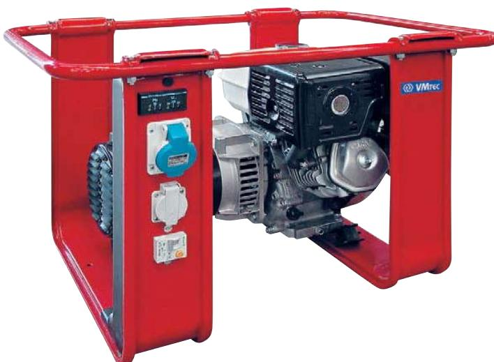
Портативные одно- и трехфазные генераторные установки с четырехтактными бензиновыми двигателями и синхронными одноопорными двухполюсными альтернаторами (класс изоляции: H), изготовленными ведущими производителями. Ручной или электрический стартер с аккумуляторной батареей. Панель управления смонтирована на раме генераторной установки. Двигатель соединен с рамой посредством виброзоляторов. Финишная порошковая окраска, красного цвета Ral 3002.
