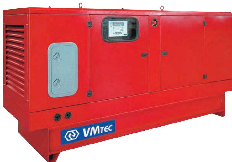
Малошумные одно- и трехфазные генераторные установки с четырехтактными дизельными двигателями и синхронными одноопорными четырехполюсными альтернаторами (класс изоляции: H), изготовленными ведущими производителями. Электрический стартер с аккумуляторной батареей. Ручная или автоматическая панель управления. Рама и кожух изготовлены из стали, оборудованы большими люками и подъемным крюком. Высокостойкая антикоррозионная финишная порошковая окраска, красного цвета Ral 3002.
