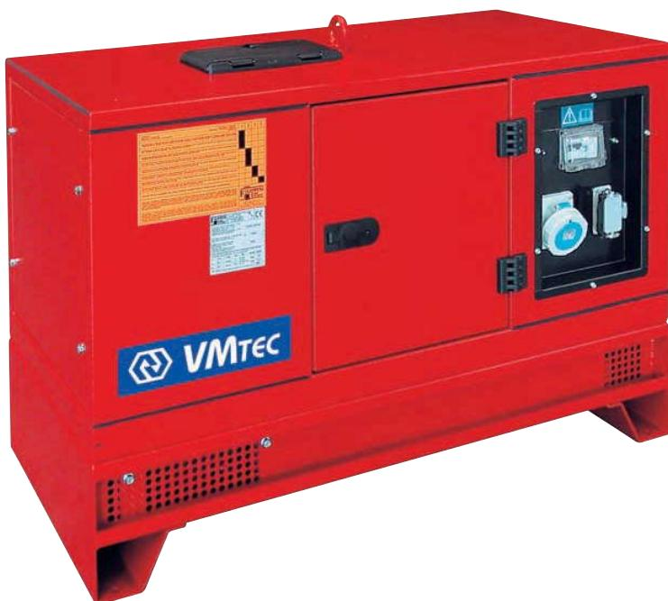
Одно- и трехфазные генераторные установки с улучшенной звукоизоляцией, четырехтактными дизельными двигателями и синхронными одноопорными двухполюсными альтернаторами (класс изоляции: Н), изготовленными ведущими производителями. Электрический стартер с аккумуляторной батареей. Ручная или автоматическая панель управления. Рама и кожух изготовлены из стали, оборудованы большими люками и подъемным крюком. Высокостойкая антикоррозионная финишная порошковая окраска, красного цвета Ral 3002.
