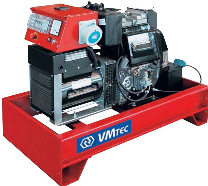
Портативные одно- и трехфазные генераторные установки с четырехтактными дизельными двигателями и синхронными одноопорными двухполюсными альтернаторами (класс изоляции: Н), изготовленными ведущими производителями. Электрический стартер с аккумуляторной батареей. Ручная панель управления смонтирована на раме генераторной установки. Финишная порошковая окраска, красного цвета Ral 3002.
