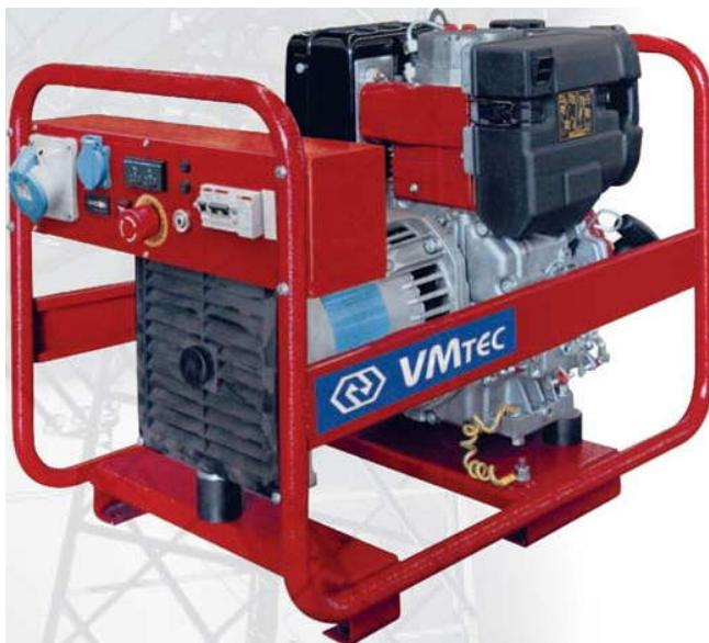
Портативные одно- и трехфазные генераторные установки с четырехтактными дизельными двигателями и синхронными одноопорными двухполюсными альтернаторами (класс изоляции: H), изготовленными ведущими производителями. Ручной или электрический стартер с аккумуляторной батареей. Панель управления смонтирована на раме генераторной установки. Двигатель соединен с рамой посредством виброзоляторов. Финишная порошковая окраска, красного цвета Ral 3002.
