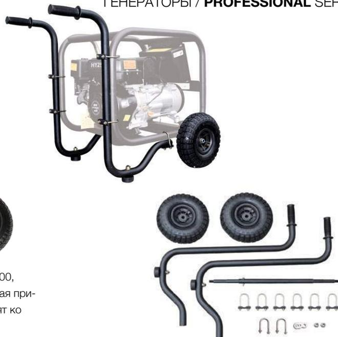
для генераторов PROFESSIONAL и DIESEL серий (wheel kit Rental). Имеет универсальные крепления, подходит для всех генераторов с рамой 32 мм.
